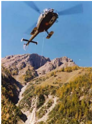
Helitransport mit dem EMD pro Rotation 350 kg
